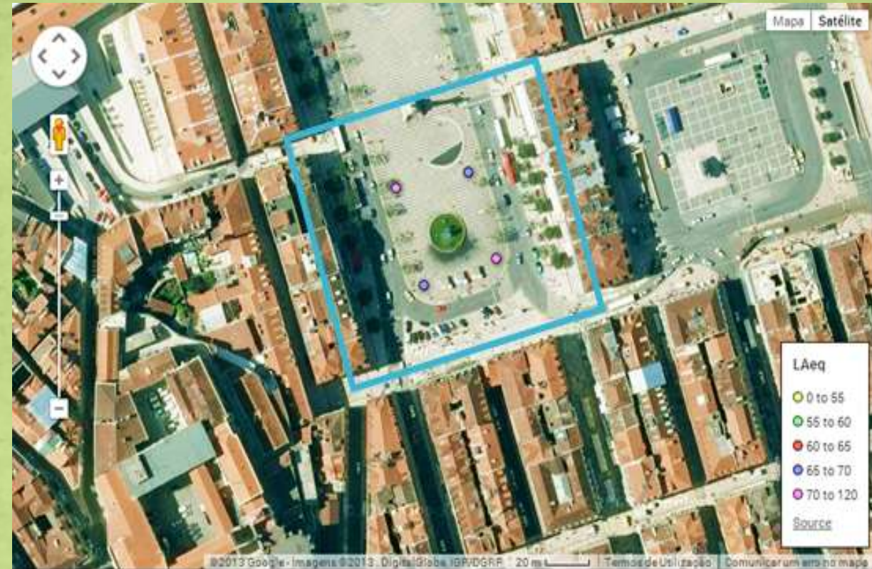
Mapa de ruído na Praça do Rossio, com uma resolução de 50 x 50 metros e baseado em medições de cinco minutos
