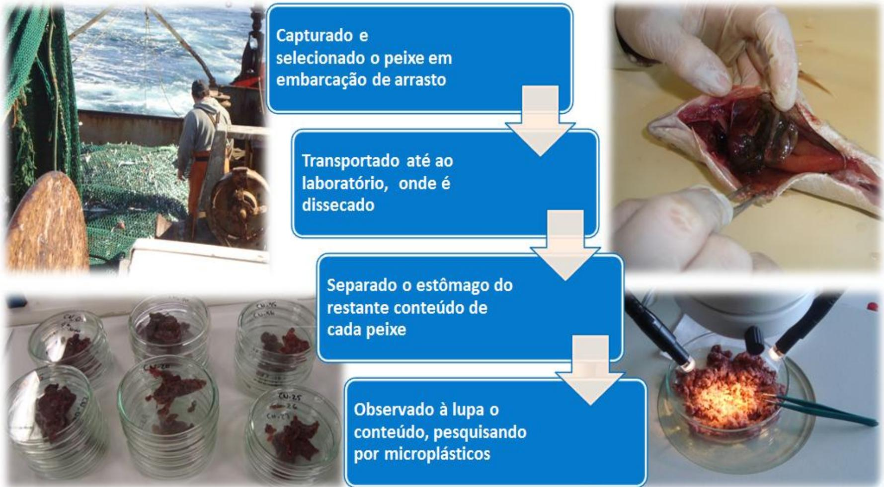
Figura 11 - Esquema geral de metodologia realizada em laboratório
